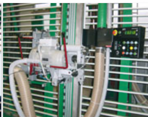
AFM 3000 řezací jednotka ▼ AFM 3000 cutting unit
