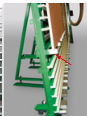
AFM 6000 vyklopná lišta ▼ AFM 6000 racks folded out
