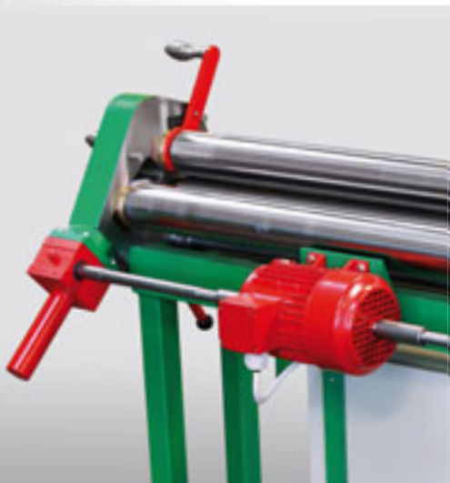
Motorický přísuv zadního válce ▼ Motor driven in-feed of the rear roller
