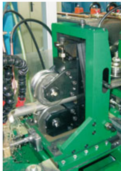
Vedení štěrby NS 42
