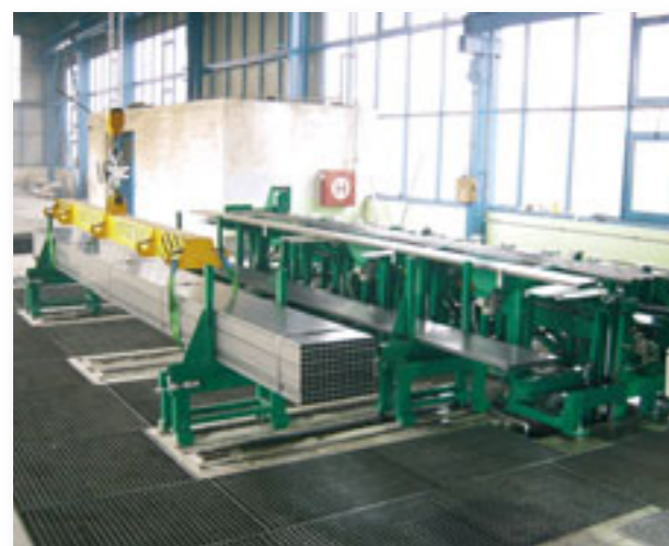
Paketování AUT 7000, profil max. 40x40x2 mm
