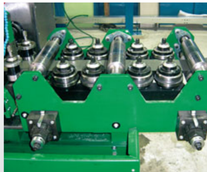
Navádění pásu HVP 320×4,0
